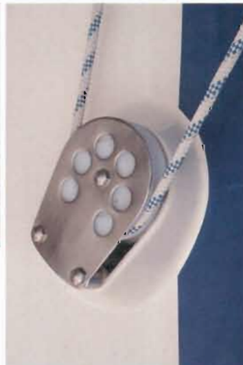
Umlenkung der Genuaschot über großscheibigen Niro-Block mit Nadellager Genoa sheet rerouted via large-disked stainless steel block with needle bearing
