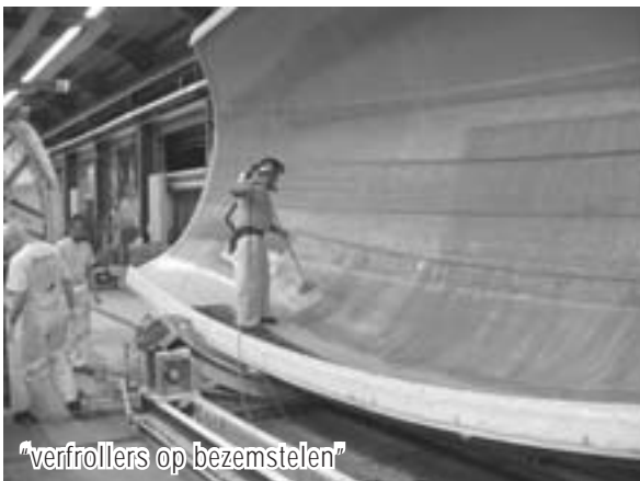
laag na laag wordt gelamineerd
