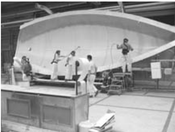
laag na laag wordt gelamineerd
